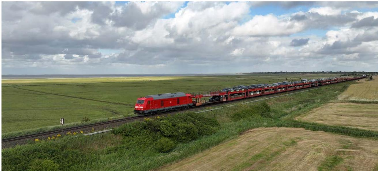
Das Sylt Shuttle der Deutschen Bahn fährt zwischen Westerland und Niebüll mit klimafreundlichem Biokraftstoff. Durch den Abschied vom Diesel werden auf der beliebten Bahnstrecke jährlich etwa 7.500 Tonnen CO<sub>2</sub> eingespart. Getankt wird an der ersten regulären Hydrotreated Vegetable Oil Schienentankstelle in Westerland.
