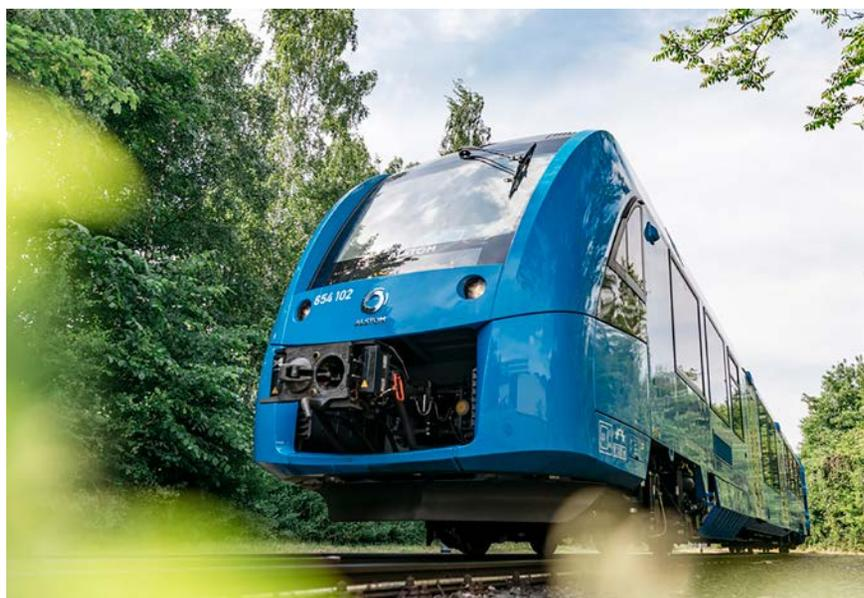
Einer der Wasserstoffzüge des Typs Coradia iLint 54 des Herstellers Alstom Transport Deutschland.
